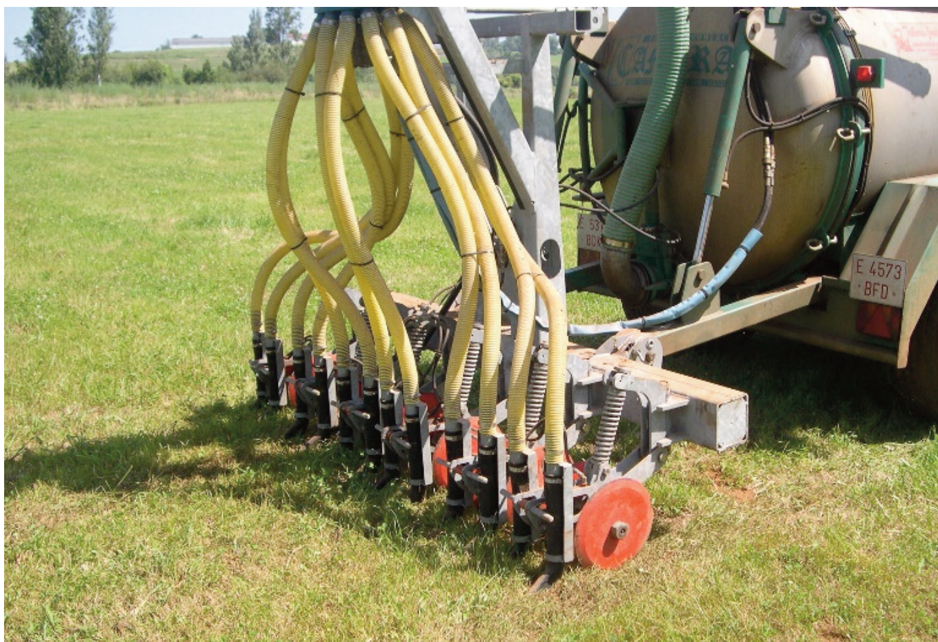
FOTO 1. Equipo de inyección de purín utilizado.
