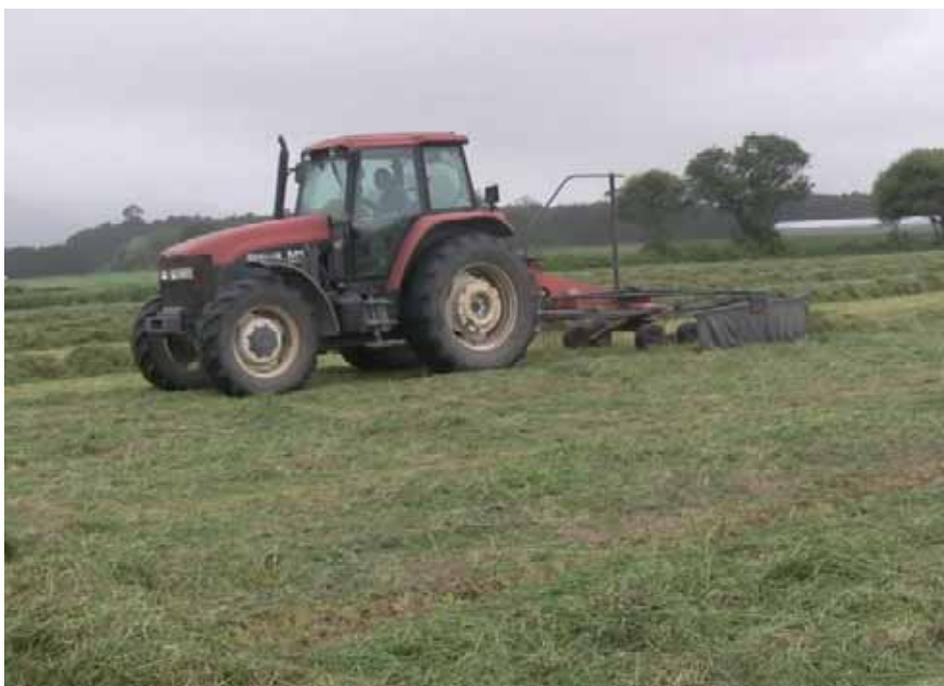
V.3(a, b).-Hilerado de forraje con rastrillo hilerador
