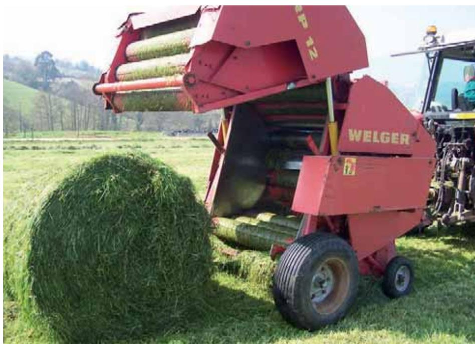
VI.2 (a, b).-Rotoempacadora de forraje en funcionamiento
