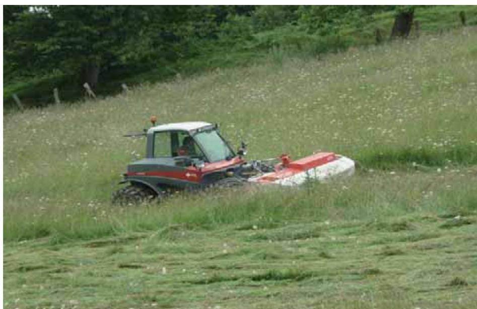
V.7.-Segadora acondicionadora acoplada a un tractor específico de montaña
